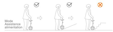
Tirez la barre de manoeuvre vers le haut pour engager le mode Assistance alimentation (allumé, sans conducteur). Pilotez le miniPRO sur des surfaces lisses à l'aide de la barre de manoeuvre. Évitez de le guider sur les escaliers, dans les trous, sur de larges surfaces fissurées/irrégulières, ou par-dessus d'autres obstacles. Guidez votre miniPRO de manière à contourner l'obstacle ou portez-le pour traverser l'obstacle, comme l'indique la section précédente.
