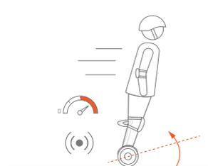
⚠️ Não acelere quando o miniPRO se inclinar para trás ou soar um alarme. Não tente ultrapassar o limitador de velocidade.
