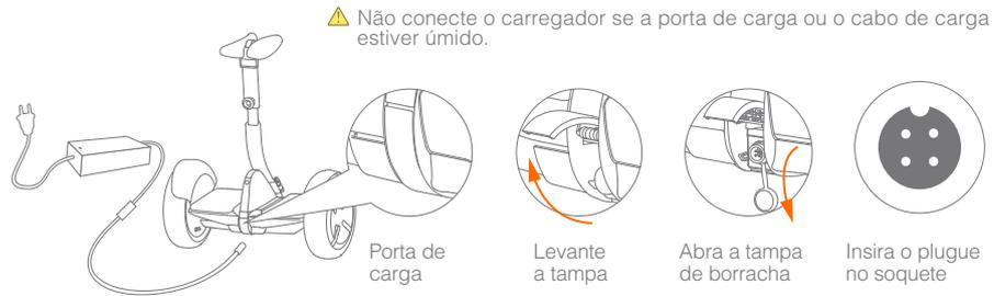
Seu miniPRO estará completamente carregado quando o LED no carregador mudar de vermelho (carregando) para verde (carga contínua).
