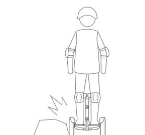
⚠️ Evite o contato de obstáculos com o pneu ou com a roda.
