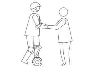
3 Trasferire lentamente il proprio peso sul miniLITE. L'unità emetterà un suono che indica la modalità Balance. Appoggiare lentamente l'altro piede.
