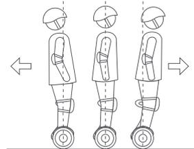
5 Piegare gentilmente il corpo in avanti e indietro per controllare i propri movimenti.
