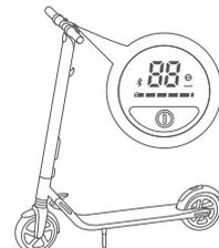
1. Allumez la trottinette et vérifiez l'indicateur lumineux du niveau de puissance. Chargez la trottinette si le niveau de la batterie est faible.
