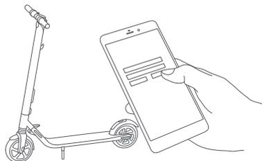
3 Cliquez sur « Vehicle » (véhicule) → « Search device » (chercher véhicule) pour connecter à votre KickScooter. Le KickScooter bipera lorsque la connexion aura réussi. L'icône Bluetooth cessera de clignoter et restera illuminée.
