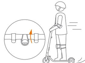
4. Ralentissez en relâchant l'accélérateur; déclenchez rapidement la manette de frein avec le pouce et tapez du pied sur le garde-boue avec votre pied en même temps pour déclencher le freinage mécanique afin de freiner fort.
