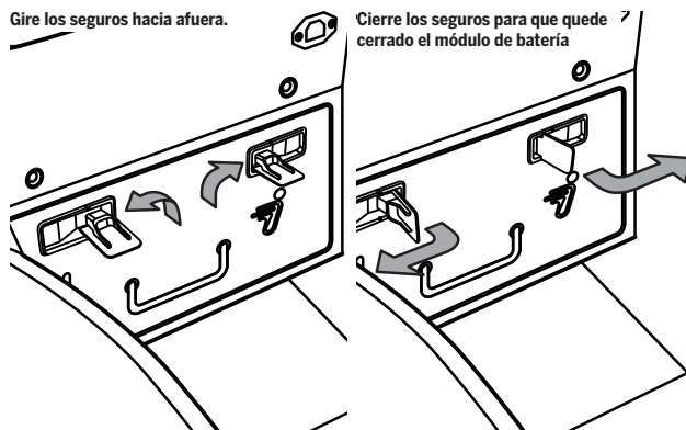
Ilustración 36: girar y cerrar los seguros del módulo de batería.
