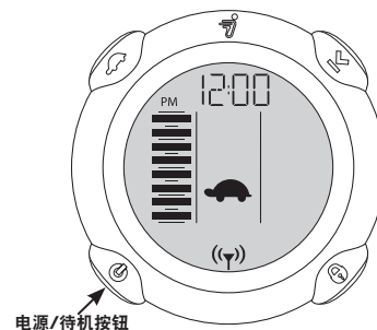
图 39：接通 PT 的电源
