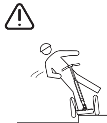
图 36：不要将一个车轮在路缘处悬空
