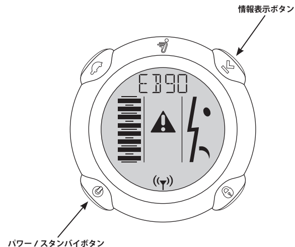
図 26. トレーニング安全シャットダウン中の InfoKey コントローラのディスプレイ表示
