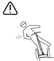
Ilustración 36: no deje que una rueda baje del bordillo
